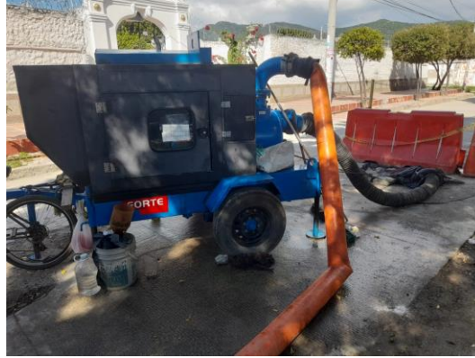
Ilustración 44: Equipo Tractobomba con cámara insonora
